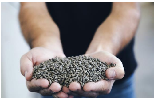
Das Granulat aus Abfällen ersetzt die Kohle in der Rohstahl-Herstellung bei ArcelorMittal.
